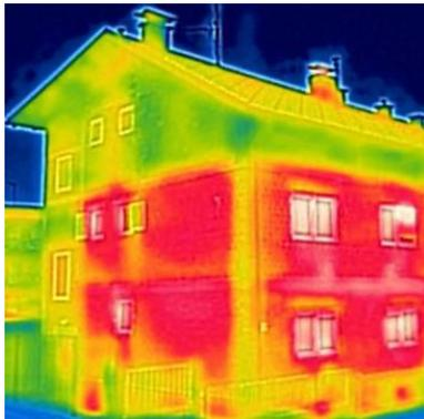
Infrarot-Kameras sind nützlich um zu sehen, wo Wärme aus einem Gebäude austritt.
