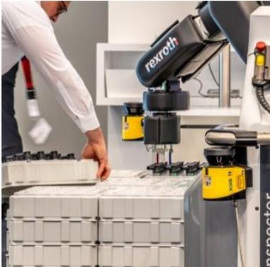
Diese Sorte Roboter heißt kooperativer Roboter.
