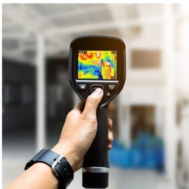
Die Bilder auf dem Bildschirm werden durch eine Infrarot-Kamera aufgenommen.
