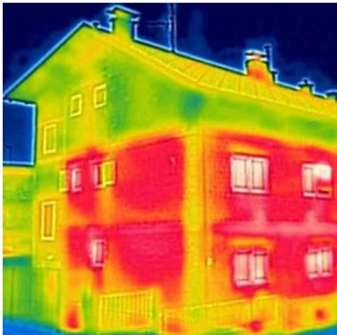
Les caméras à infrarouge sont utiles pour voir d'où la chaleur s'échappe d'un bâtiment.
